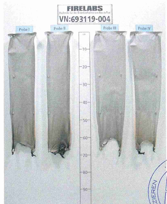
Bild 8 Aussehen des Probekörpers nach dem Brandversuch
